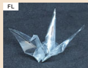
ネोजェット FLを使ったシート状の硬化物で作成した折鶴 ⇒硬化物の韌性が高いため、割れ等発生しない。
