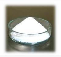
半導体封止材とは、半導体を光、熱、湿気、ほこりや衝撃などから保護する半導体パッケージを構成する材料のひとつです。エポキシやシリコーンなどの樹脂材料、硬化剤、充填剤(フィラー)、添加剤で構成されます。添加剤の1種にアニオン吸着剤があり、ハイドロタルサイトはその材料として使用されています。ハイドロタルサイトが樹脂材料に含まれる塩素イオンを捕捉し、配線回路の断線を防ぎます。
